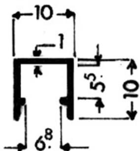
Tra i profili speciali realizzati da Profilati Alluminio, vi sono i profili fermavetro in alluminio: si tratta di profili speciali a disegno che trovano applicazione nell'assemblaggio di porte e finestre, quindi nel settore dell'arredo e dell'edilizia.
